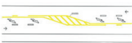
ILHAS DE CANALIZAÇÃO ENVOLVENDO OBSTÁCULOS NA PISTA
